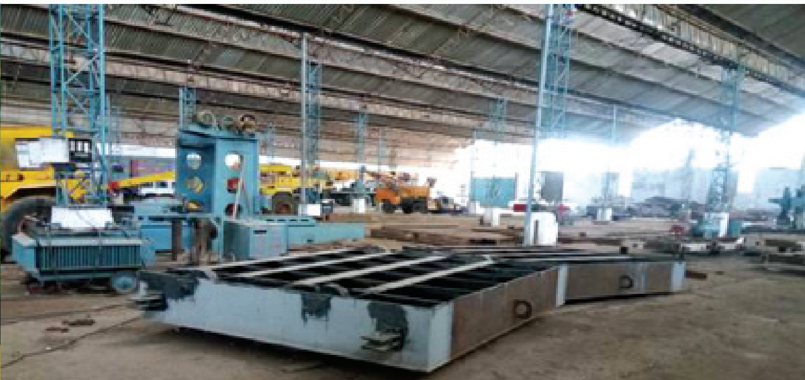
वर्टिकल लिफ्ट फिक्स वील गेट का निर्माण (केन्द्रीय यांत्रिकी इकाई भोपाल)
